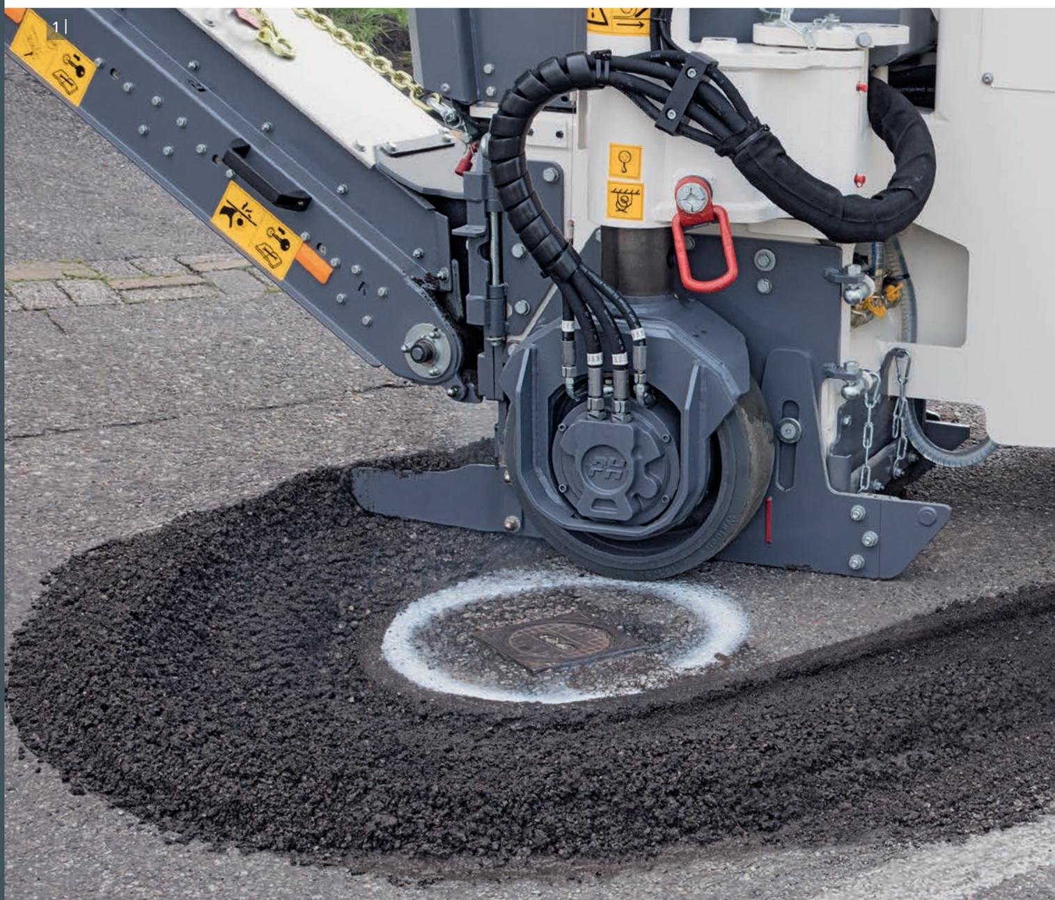
1 | - 2 | 電気制御走行は、例えば道路設備に沿った正確な切削を可能にします。
