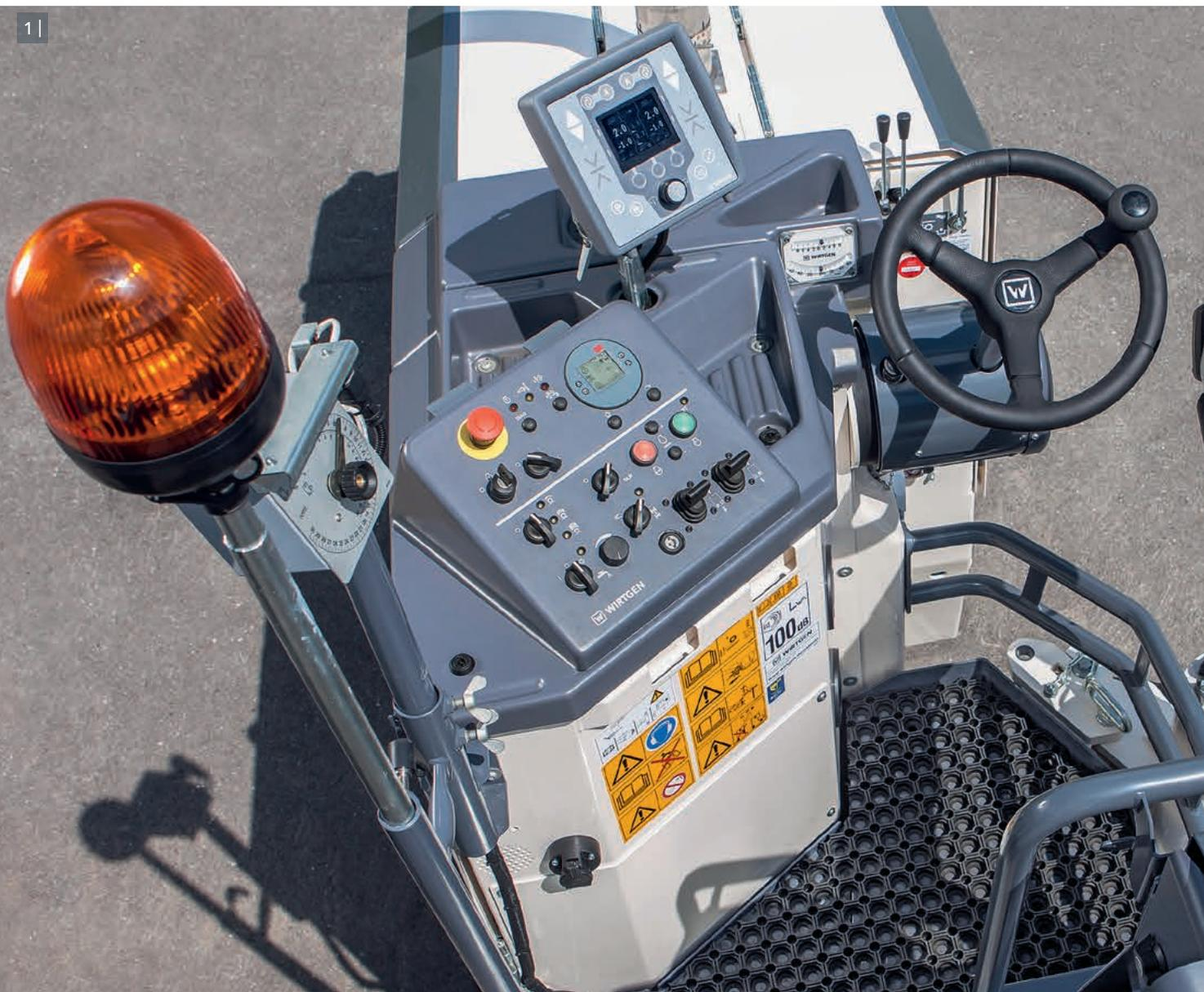
1 | 多機能アームレストを備えた人間工学に基づいて設計されたオペレータープラットフォームは、機械の生産性を向上させます。
