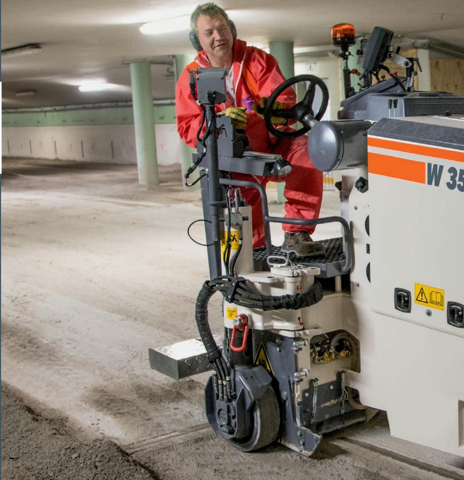
優れた操作性を備えたこの小型路面切削機は、限られた条件のスペースでの切削作業などに理想的に対応する路面切削機です。
