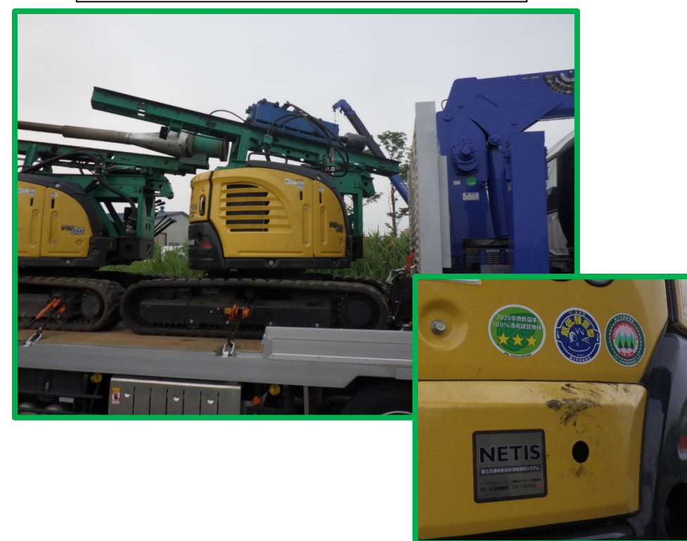
クローラ型支柱打込機【VIO30(改) (U)】 (中間・端末スリーブ管打込用)
