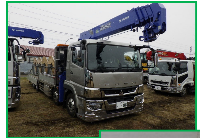
11t積 大型ユニック車(ワイヤー架台用)
