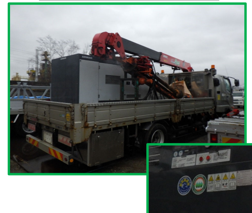
吊下げ式岩削機【KT100DTH】 コンプレッサー搭載【PDSF315SC】 (端末鋼管部岩削用)
