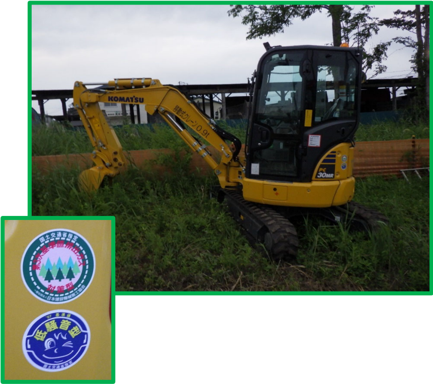
0.15m 3 級バックホウ【PC30MR】 (PCC・RP撤去用)
