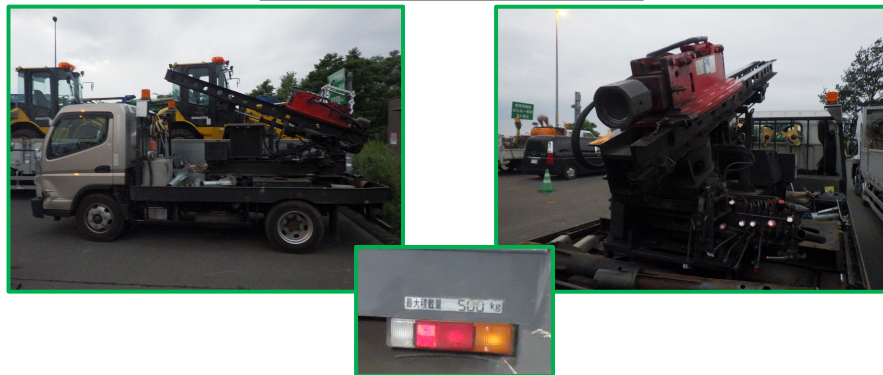
車両型支柱打込機(ストライカー)【A・O-3500】 (端末鋼管打込み用)
