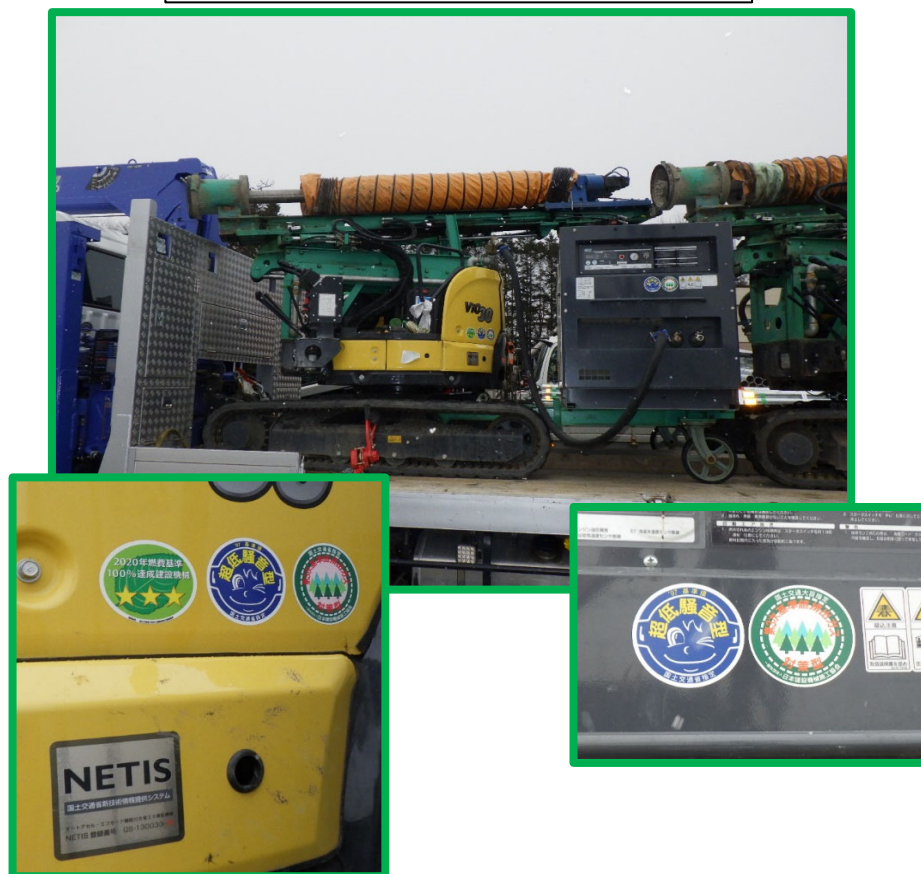
クローラ型岩削機【VIO30(改) (G)】 コンプレッサー搭載【PDS185SC】 (中間・端末支柱岩削用)
