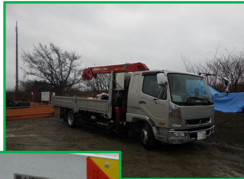
4.6t積 中型ユニック車(資材運搬用)
